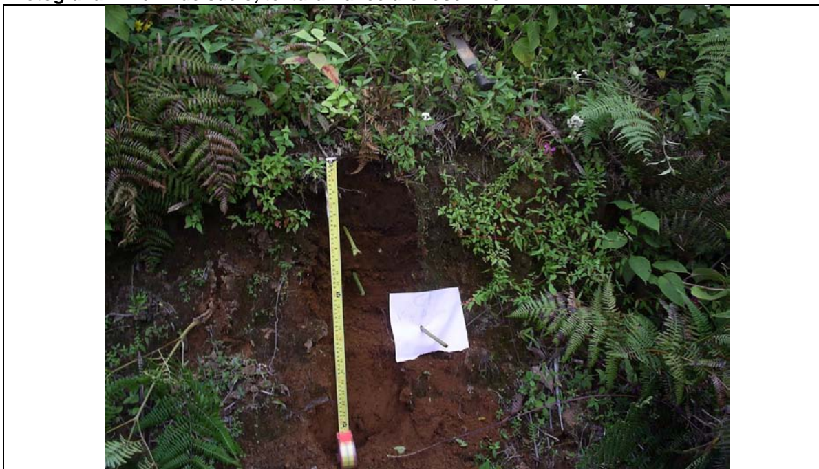
Fotografía 2. Perfil de suelo, textura franco arenoso fino.
