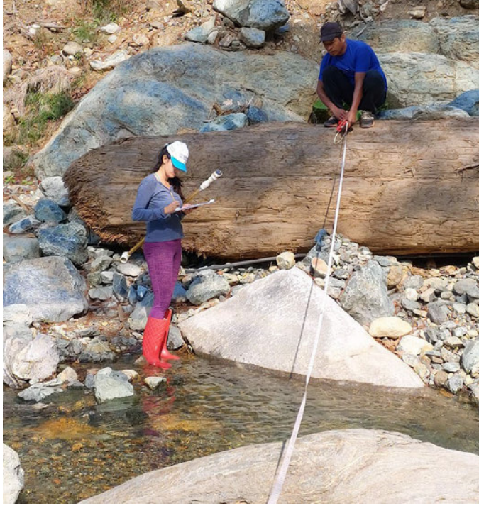
Anexo 2. Medición del ancho del río
